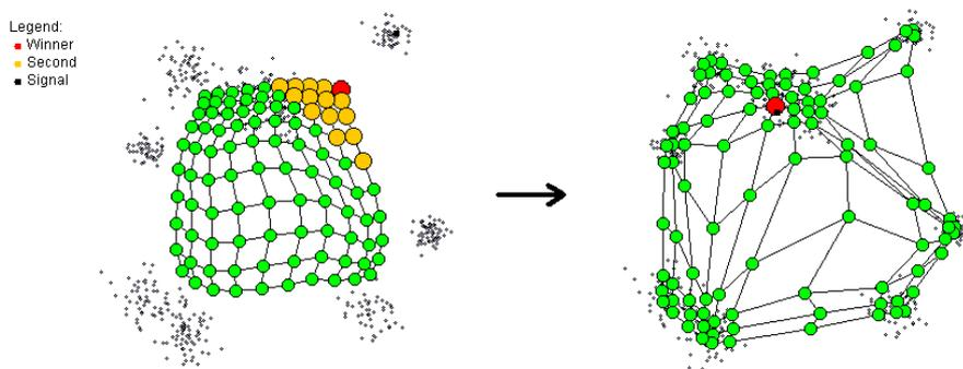
Abbildung 1: Training eines Kohonennetzes ohne Dimensionsreduktion. Auf der linken Seite sieht man das Netz und die aktivierten Neuronen am Beginn des Trainings. Auf der rechten Seite sieht man ein fertig trainiertes Netz.[1]
